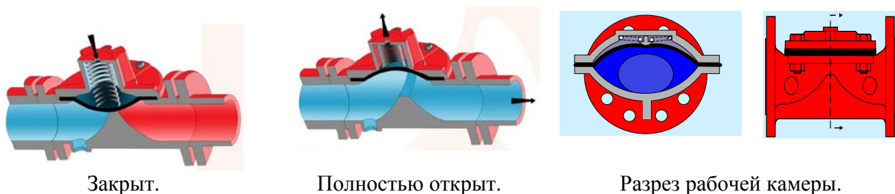
Рис. 5. Конечные положения регулирующей мембраны.
