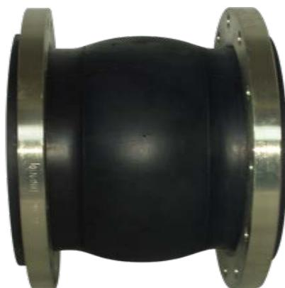
Резинокордные компенсационные вставки служат для компенсации монтажных, температурных и рабочих смещений, соединяемых трубопроводов, а также для снижения уровня вибрации и шума трубопроводов и насосных установок. Используются для облегчения монтажа и демонтажа задвижек, устанавливаются вместо задвижек на период их ремонта, монтируются на всасывающих и напорных линиях насосных установок.
